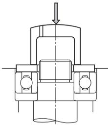
Abb. 14.2 Gleichzeitiges Montieren von Innen- und Außenring
