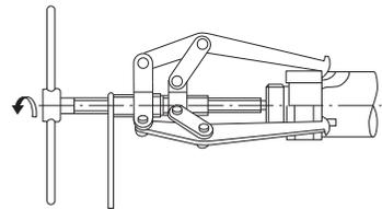
Abb. 14.14 Demontage des Innenrings mit Abziehwerkzeug (2)
