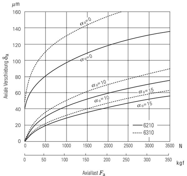
Abb. 15.2 Axiallast und axiale Verschiebung von Rillenkugellagern
