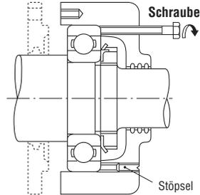
Abb. 14.10 Demontage des Außenrings mittels Schrauben
