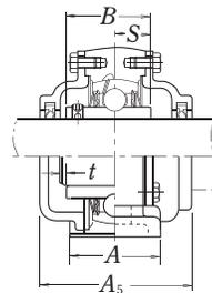
**Gusseisen, Ausführung mit Staubabdeckung**
