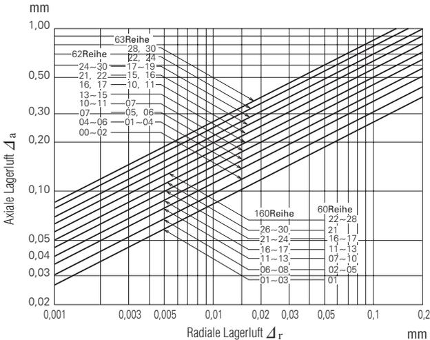
Abb. 15.7  $\Delta_r$  und  $\Delta_a$  in einreihigen Rillenkugellagern
