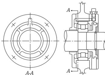
Abb. 12.1 Kombination untergliederter Fettbehälter und Fettventil
