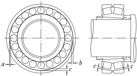
Abb. 14.9 Messen des Spiels bei einem großen Pendelrollenlager
