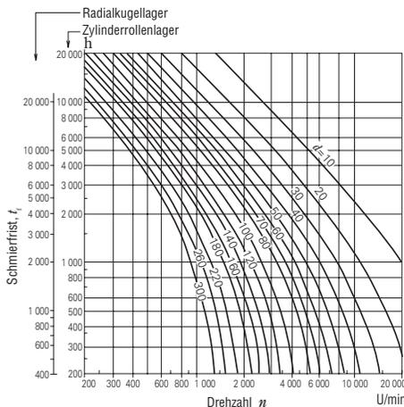
(1) Radialkugellager, Zylinderrollenlager
