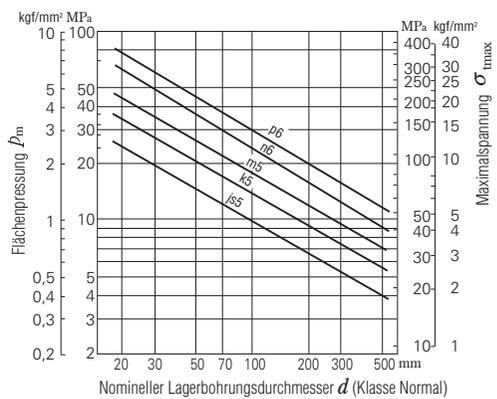
Abb. 15.6 Flächenpressung  $P_m$  und Maximalspannung  $\sigma_{tmax}$  für maximales Übermaß
