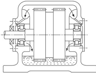
Abb. 12.6 Ölsprühschmierung
