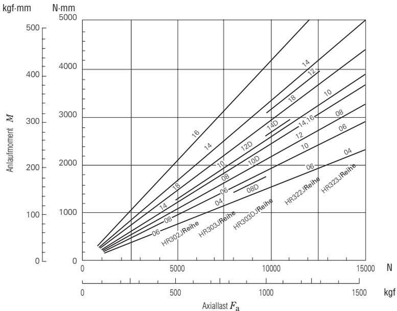
Abb. 15.10 Zusammenhang zwischen Axiallast und Anlaufmoment von Kegelrollenlagern
