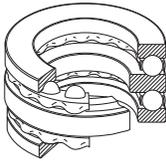
Es gibt auch Axial-Kugellager mit einstellbaren Unterlagscheiben unter den Gehäusescheiben um einen Wellenversatz oder Einbaufehler auszugleichen.
