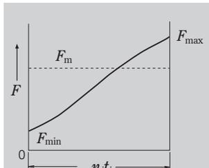
Abb. 5.8 Einfache Lastschwankung
