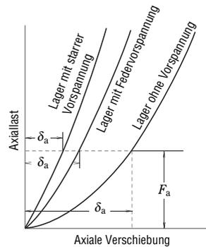
**Abb. 10.6 Vergleich von Steifigkeiten und Vorspannmethoden**
