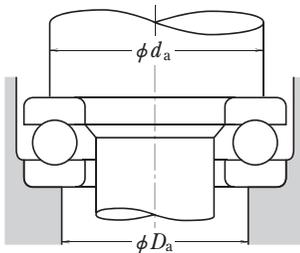
Abb. 11.3. Einbaumaße Axialkugellager
