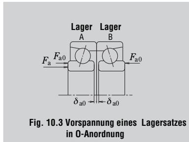
**Fig. 10.3 Vorspannung eines Lagersatzes in O-Anordnung**
