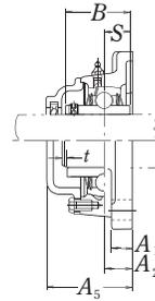
**Stahlblech, Ausführung mit Staubabdeckung**
