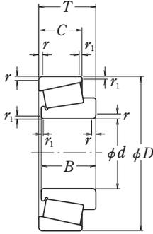
Abb. 7.2 Kegelrollenlager
