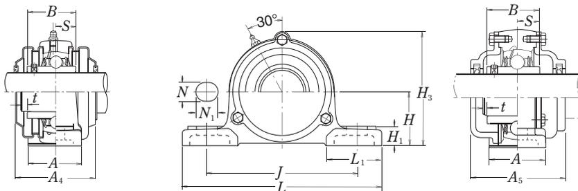
**Gusseisen, Ausführung mit Staubabdeckung**
