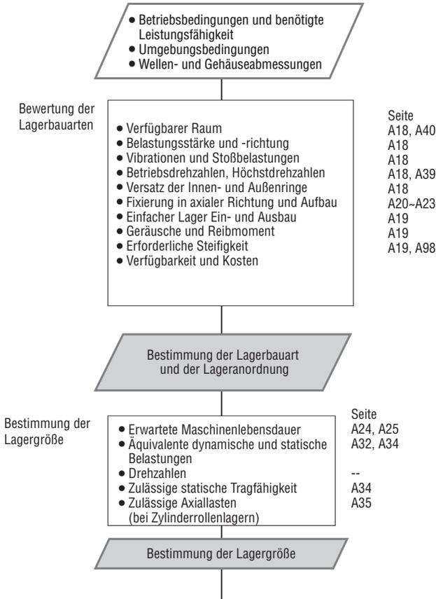
**Abb. 2.1 Ablaufplan für die Auswahl von Wälzlagern**
