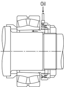
Abb. 14.6 Montage mit Hydraulikmutter
