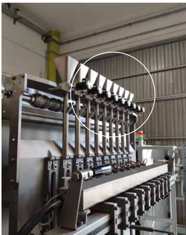
K (vibratore pneumatico lineare) - Svuotamento tramoggia
